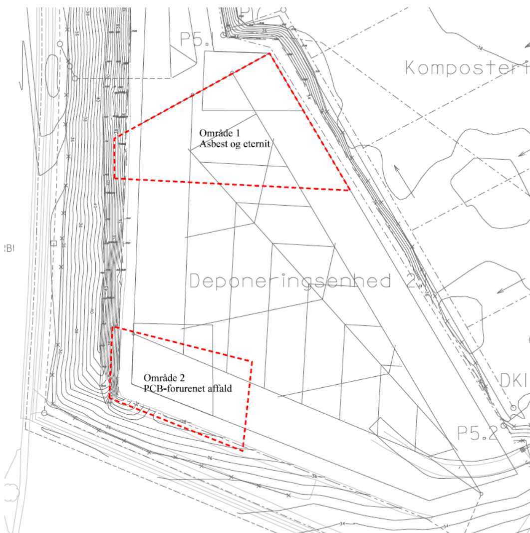
Figur 3 Mineralsk og blandet affaldscelle med PCB og asbest – og eternitafsnit.
