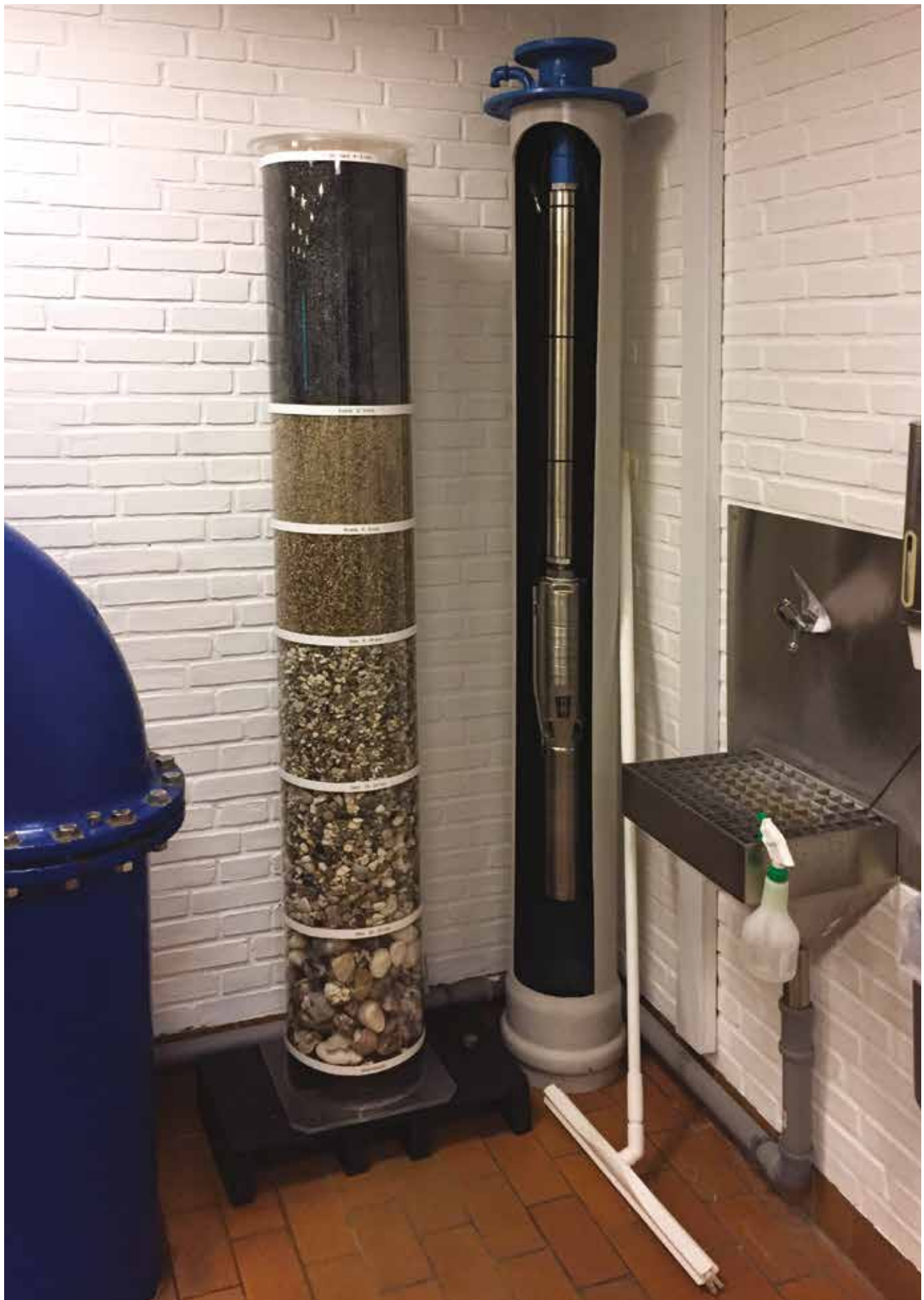
Til venstre ses et tværsnit af et filter. Cylinderen til højre viser den pumpe, som sidder i selve borerøret i alle vandboringerne.
