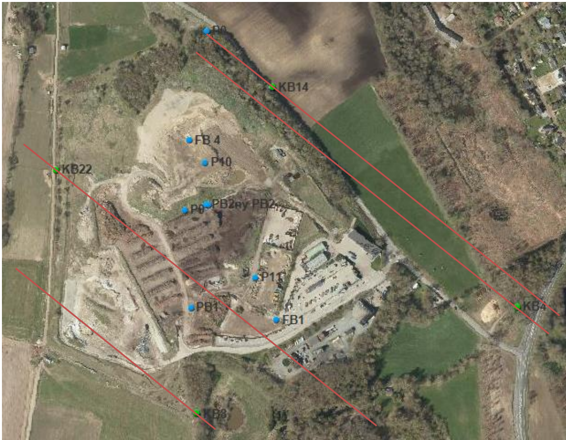
Figur 6 Luftfoto med placering af pejle- og pumpeboringer (som benyttes fra 2018) Røde streger er potentialelinier, hvorpå strømretningen i det øvre grundvandsmagasin er vinkelret.
